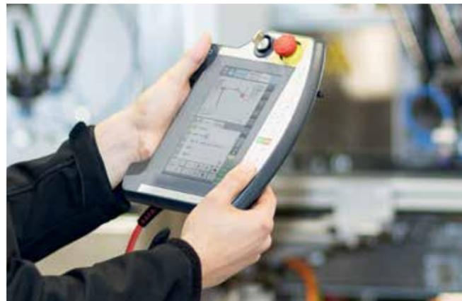
Der RobotMonitor lässt sich sowohl auf PCs als auch auf Handhelds oder Tablets mit Windows Betriebssystem ausführen. Dadurch steht dem Anwender die gleiche Bedienoberfläche auf allen Geräten zur Verfügung.
