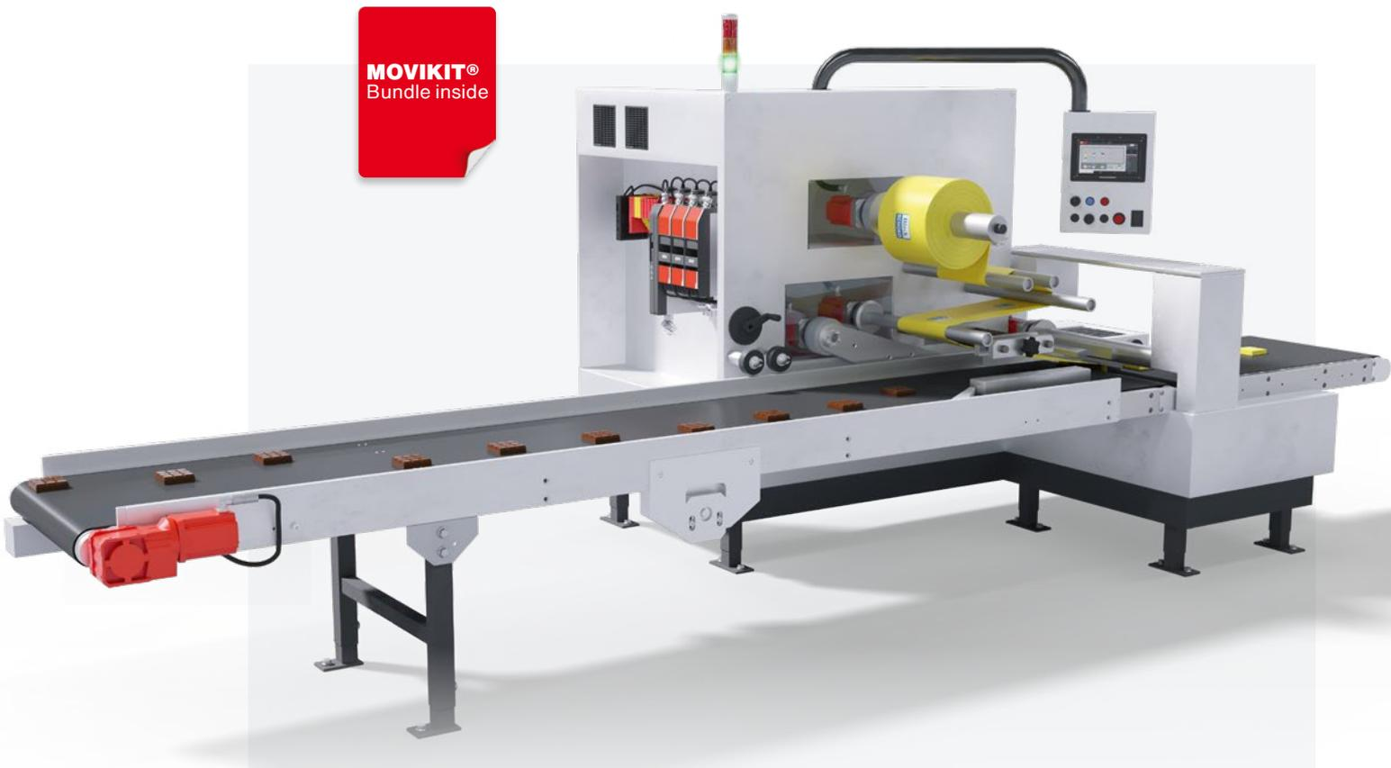
Für das Verpacken von einzeltem Stückgut wie Schokoriegel oder Kekse sind horizontale Schlauchbeutelmaschinen sehr geeignet – nicht nur im Lebensmittelbereich. Bei horizontalen Schlauchbeutelmaschinen werden die Produkte vereinzelt und separiert verpackt. Automatisierung von SEW-EURODRIVE ermöglicht hier schnelle, unkomplizierte und automatische Formatwechsel. Damit haben Hersteller mit einer Verpackungsmaschine unterschiedliche Produkte und Beutelgrößen perfekt im Griff.
