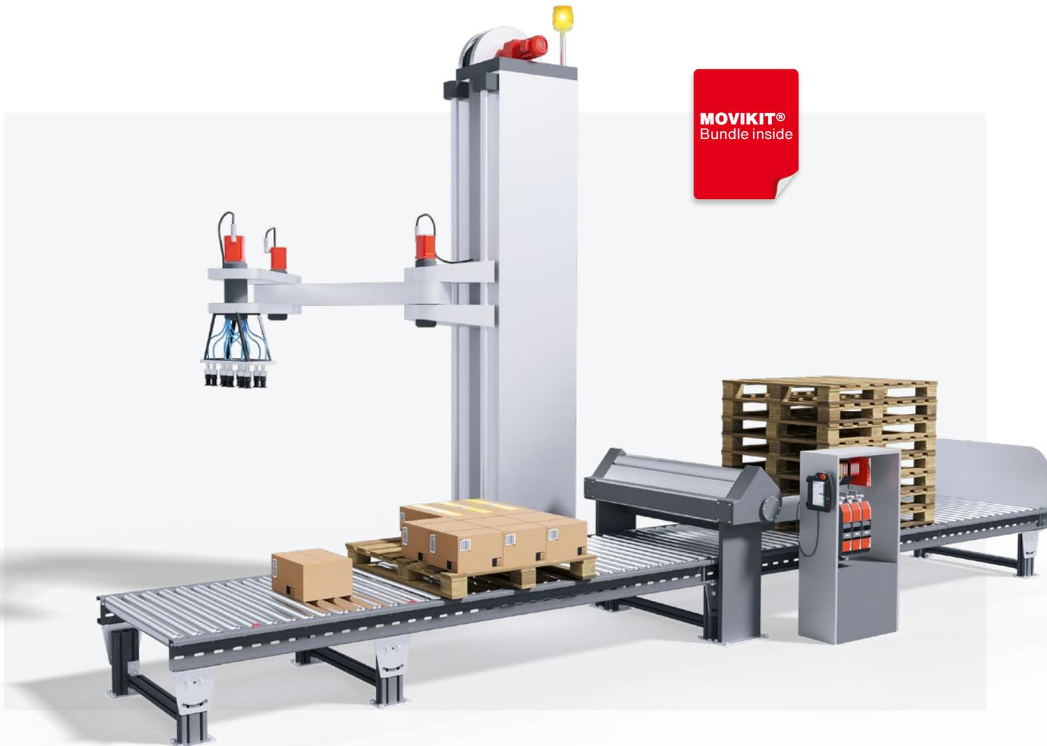
Der Palettierer oder Palettierroboter ist ein System der Prozessautomatisierung, um automatisch Packstücke auf Ladungsträgern zusammenzufassen. Es gibt grundsätzlich vier verschiedene Arten von Palettierern: Knickarmroboter, Lagenpalettierer, Linearroboter und Portalpalettierer. Packgröße, Packgewicht und besonders der Arbeitsraum sind dabei entscheidend für die Maschinenfunktionen und Bewegungen.
