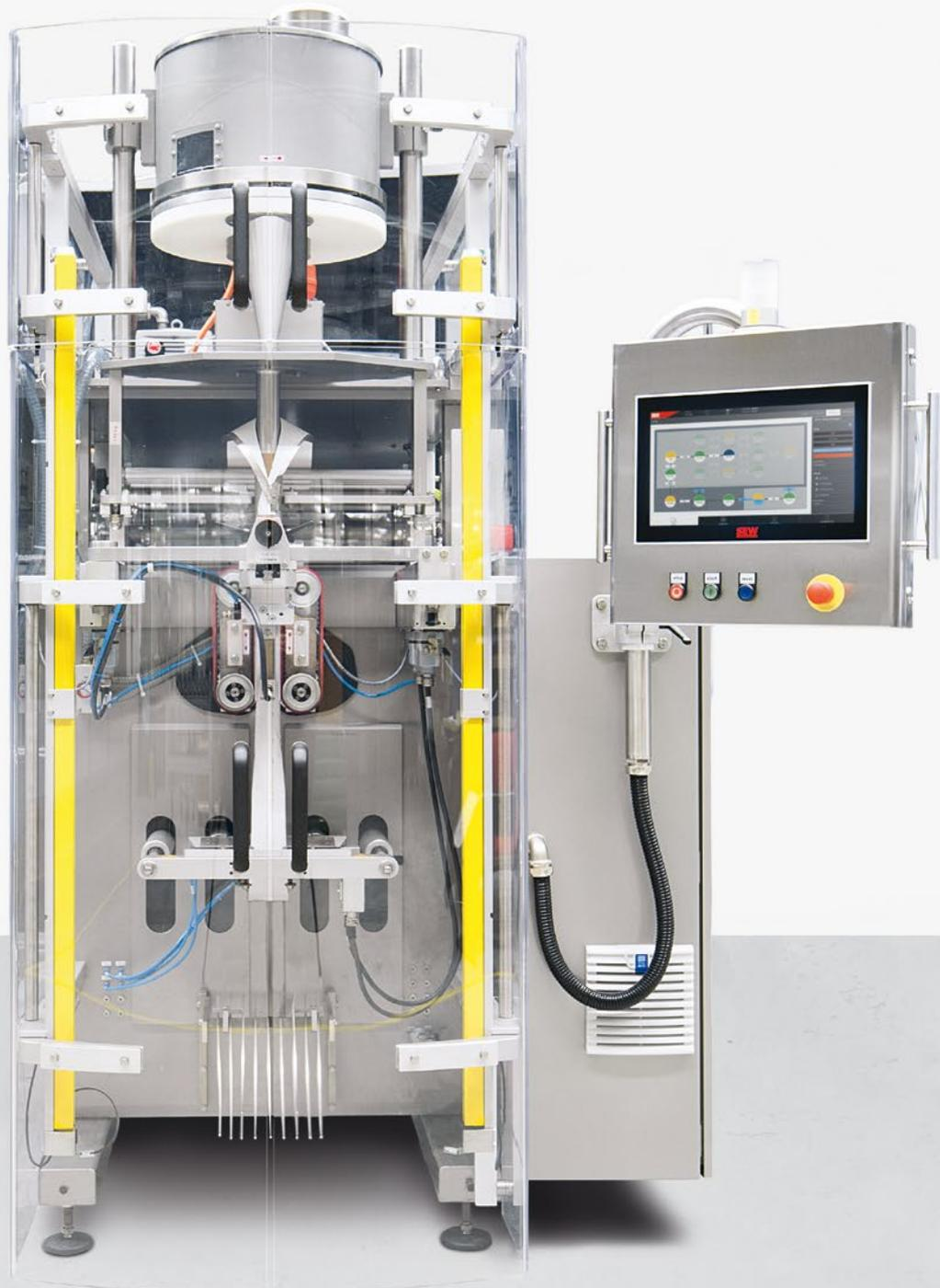
→ **Vertikale Schlauchbeutelmaschine**
