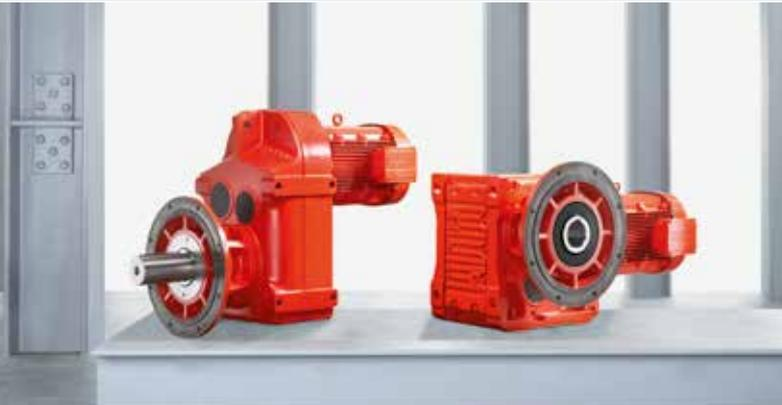
Die **Stirnrad-, Kegelstirnrad- und Flachgetriebe-Baureihen** stehen auch als Ausführung für Rührwerke und Mischer zur Verfügung. Durch die verlängerte Lagernabe sind sie in der Lage große Querkkräfte aufzunehmen. Die Wellen und Flanschmaße sind kompatibel zu marktüblichen Abmessungen wodurch bestehende Getriebe in der Regel ohne konstruktive Anpassungen ersetzt werden können. Optional sind die Getriebegehäuse auch in EN-GJS-400-15 (GGG40) verfügbar.
