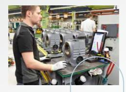
Als fahrende, intelligente Werkbank unterstützt der mobile Montageassistent den Mitarbeiter mit Informationen und entlastet ihn ergonomisch.
