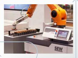
Im Bereich der zerspanenden Fertigung wird der Mitarbeiter durch den Einsatz eines mobilen Handlingassistenten entlastet, welcher die Bestückung und die Werkstückentnahme übernimmt.
